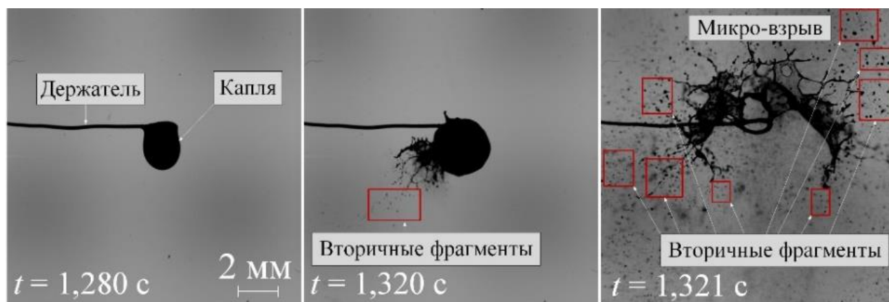
Рисунок 2. Схема регистрации характеристик микро-взрывного распада двухжидкостной капли (вода/рапсовое масло) и образования вторичных фрагментов ( R_{d0} \approx 0.85 мм, T_a \approx 650 К, объемная концентрация воды 10 %)
